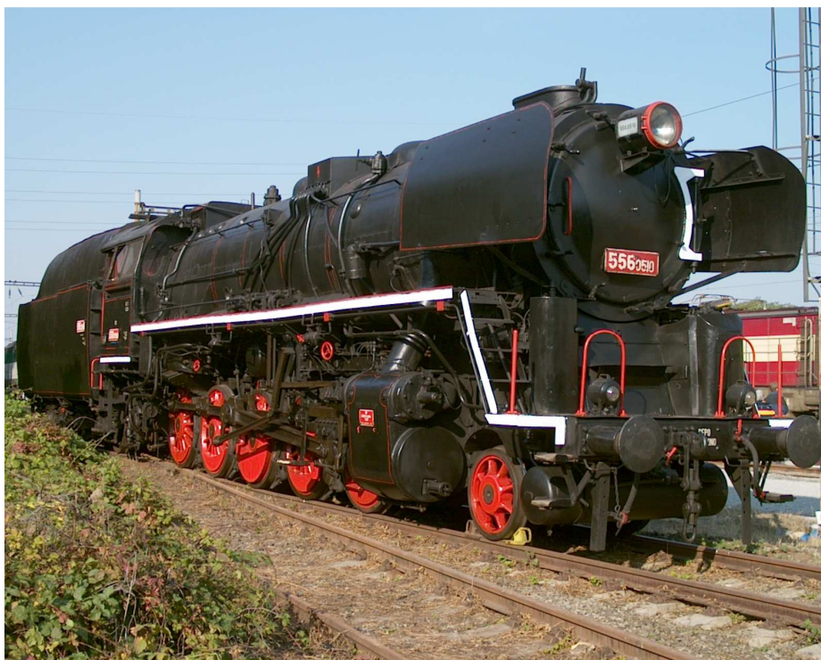
Lokomotivy řady 556 se vyráběly od r. 1951. Na fotografii je poslední vyrobená lokomotiva této řady 556.0510, kterou převzaly ČSD r. 1958. Tyto silné parní lokomotivy se postaraly o mnoho rekordů. Absolutní rekord v délce i hmotnosti vlaku u nás drží jízda vlaku ze dne 20. prosince 1958 z Kojetína do Ostravy. Vlak měl 121 vozů (484 náprav), hmotnost 8272 tun a délku přes 1,8 km. Tento monstrózní vlak daly do pohybu dvě lokomotivy řady 556 (jedna vpředu, jedna na postrku). Foto autor, 2003
